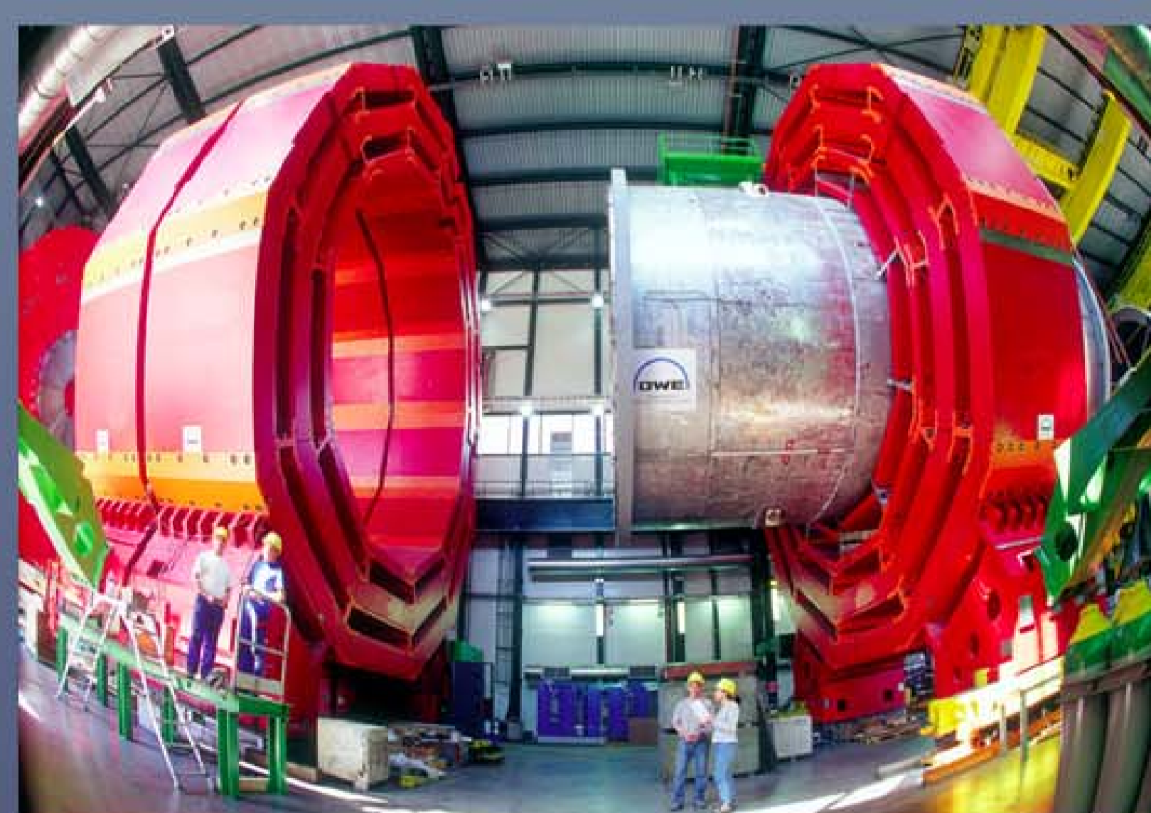
Culasse de l'aimant de CMS, qui fournira un champ magnétique de 4 Tesla.
